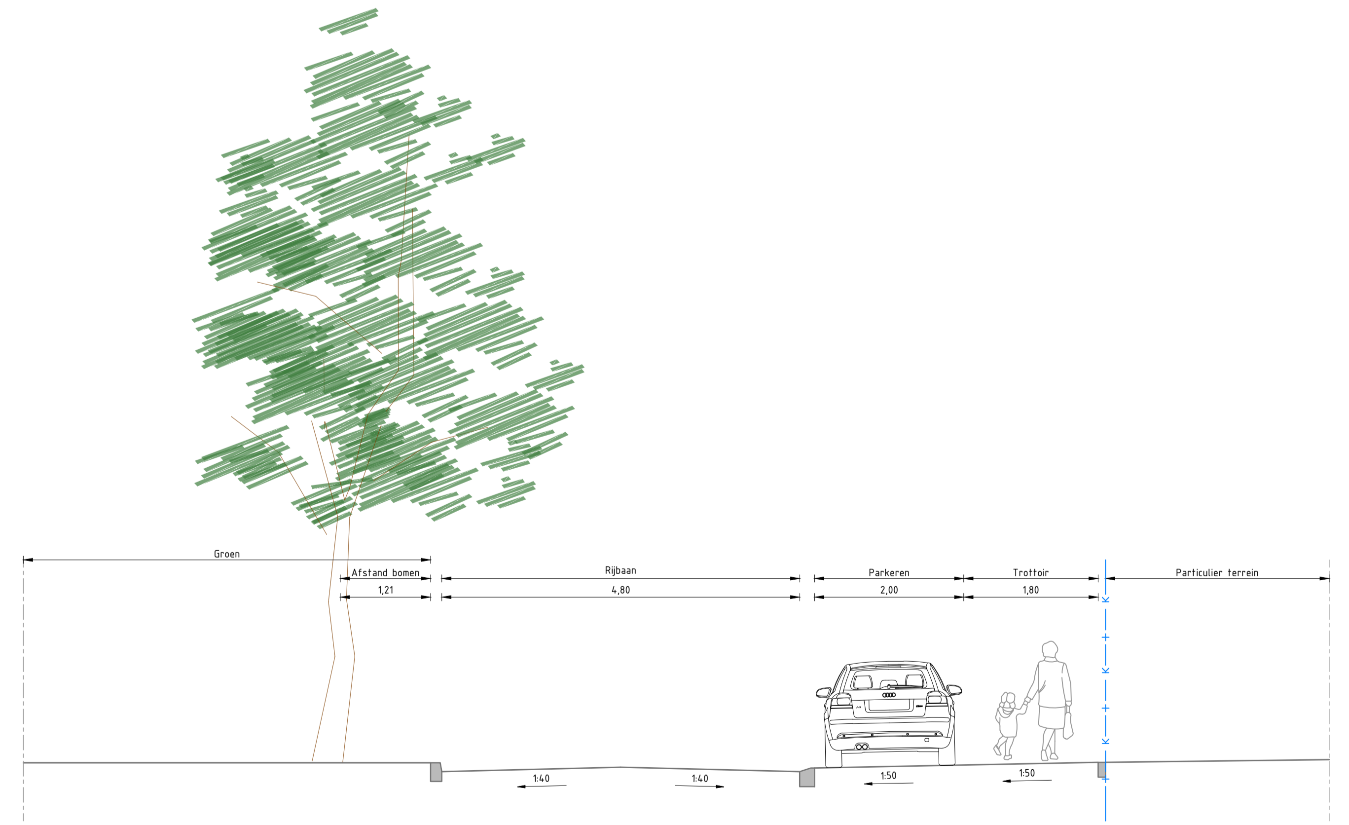
OPTIE NIEUWE SITUATIE Doorsnede Schaal 1:50
