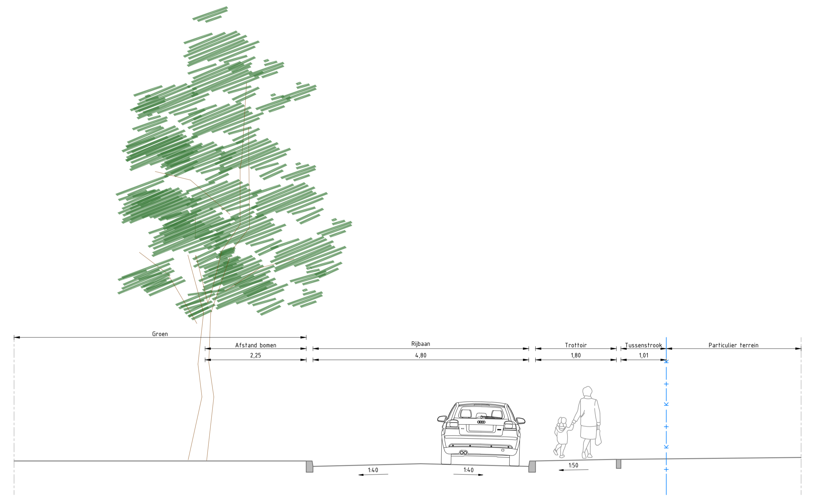
OPTIE NIEUWE SITUATIE Doorsnede Schaal 1:50
